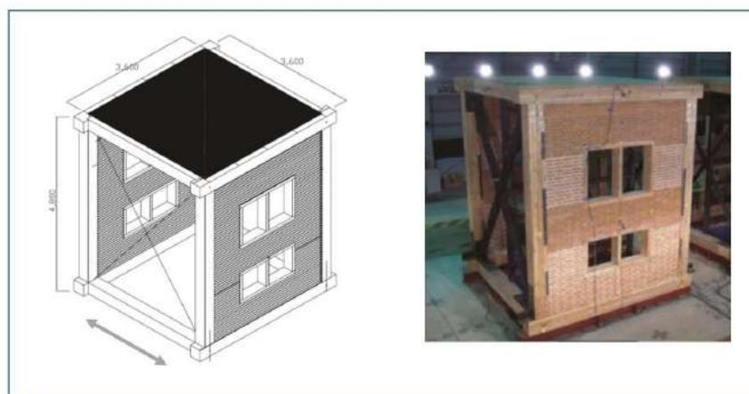
Modello in scala reale sottoposto a test su tavola vibrante
